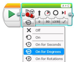
Figura 10: Configuração da medida de duração do movimento do motor.
