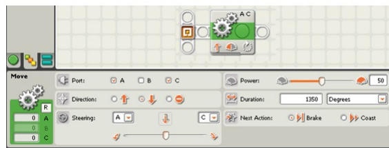
Figura 14: Palheta de configuração do bloco Move
