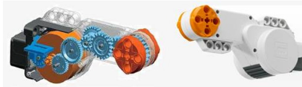
Figura 10 - Servo motor com suas engrenagens internas
